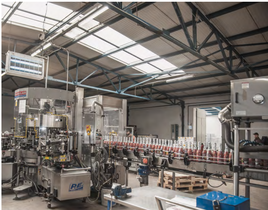
Rozlewnia wina – urządzenie do nakładania etykiet
