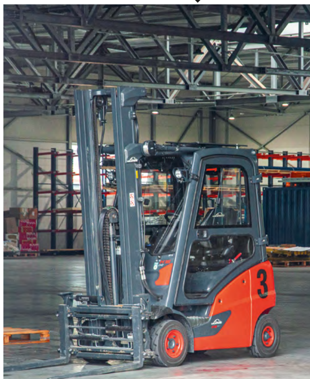
Linde H16T z 2019 roku – wózek czołowy zasilany elektrycznie o udźwigu 1600 kg przeznaczony do prac związanych z utrzymaniem ciągłości produkcji
