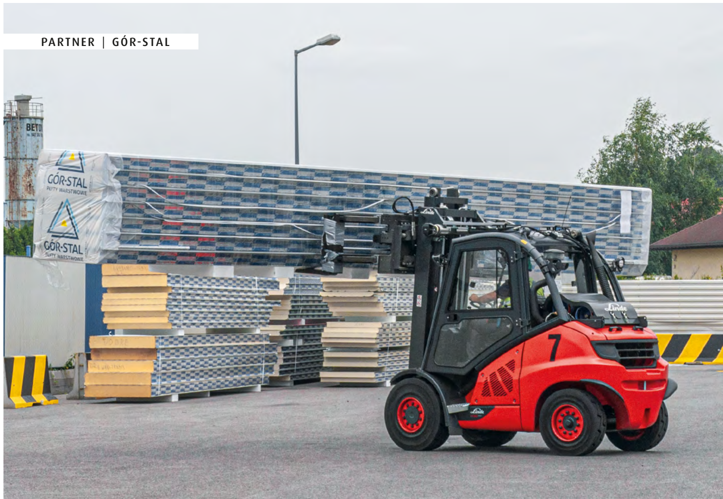
Linde H16T z 2019 roku – wózek czołowy zasilany elektrycznie o udźwigu 1600 kg przeznaczony do prac związanych z utrzymaniem ciągłości produkcji
