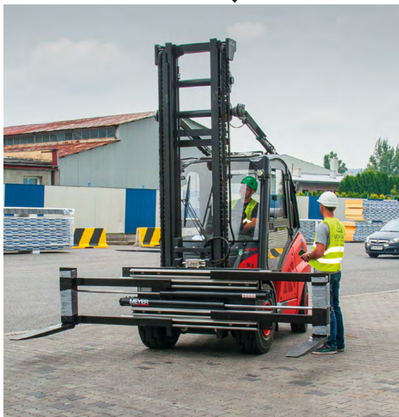
Linde H50T z 2019 roku – wózek czołowy zasilany LPG o udźwigu 5000 kg przeznaczony do załadunków pakietów na samochody z możliwością pobrania 6-metrowej trawersy
