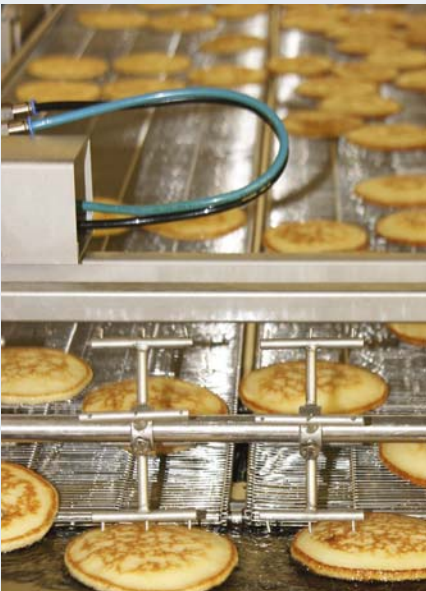
Na zdjęciu pierwsza w Polsce i tej części Europy automatyczna linia do smażenia przy użyciu minimalnej ilości tłuszczu, konfekcjonowania i pakowania szerokiego asortymentu dań garmażeryjnych m. in. placków ziemniaczanych, naleśników, racuchów, kotletów i sznycli.
