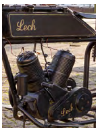
Po pierwszym polskim motocyklu Lechu pozostał jedynie pomnik. Maszynę produkowano w latach 1929-1932, miała dwucylindrowy silnik o pojemności około 500 cm 3 , a jej prędkość maksymalna oscylowała wokół 75 km/h
