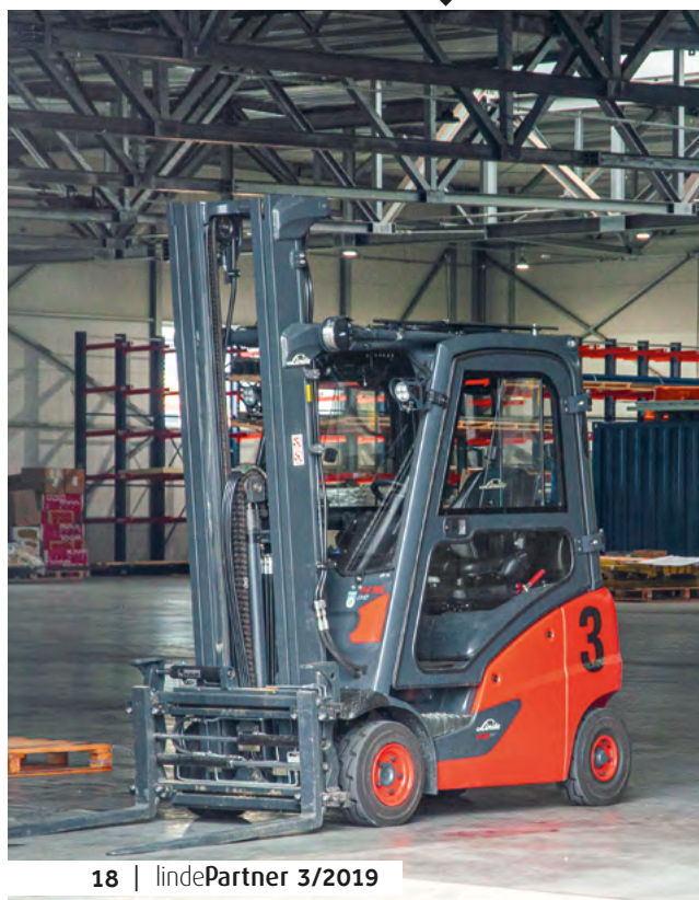
Linde H16T z 2019 roku – wózek czołowy zasilany elektrycznie o udźwigu 1600 kg przeznaczony do prac związanych z utrzymaniem ciągłości produkcji
