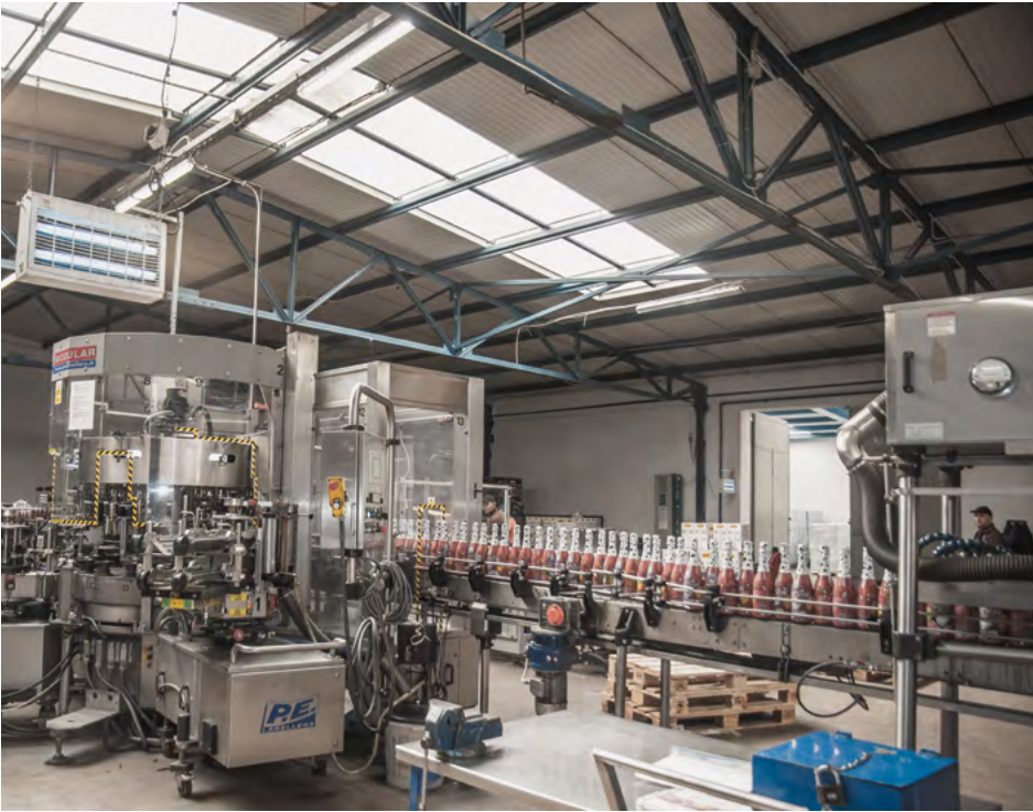
Rozlewnia wina – urządzenie do nakładania etykiet
