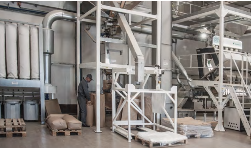
Pierwszą działalnością firmy była produkcja suszu warzywnego do przypraw. Ta część działalności prowadzona jest również dzisiaj. Warzywa są krojone w rozdrabniarkach, skąd trafiają do automatycznej suszarni.
