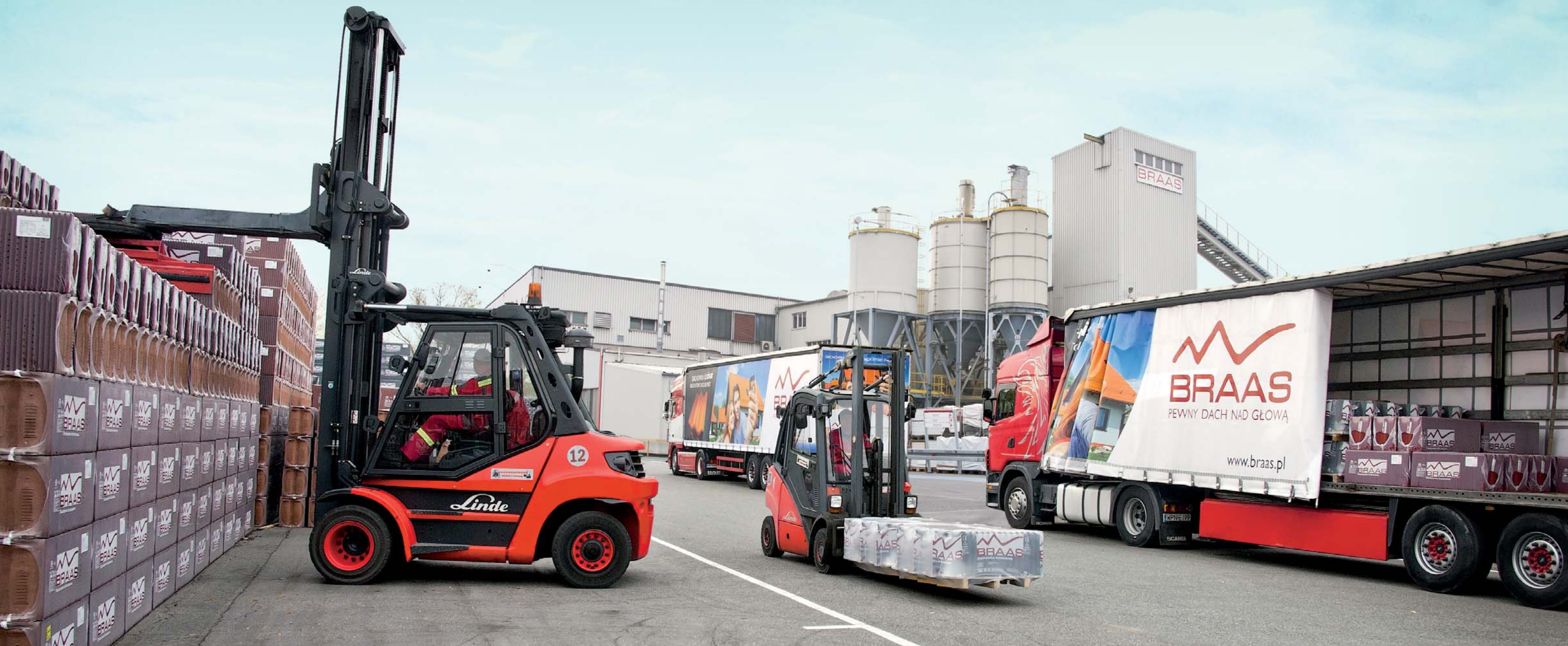
Wózek H80D z serii 396 specjalnym chwytnikiem do dachówki transportuje gotowy produkt.
