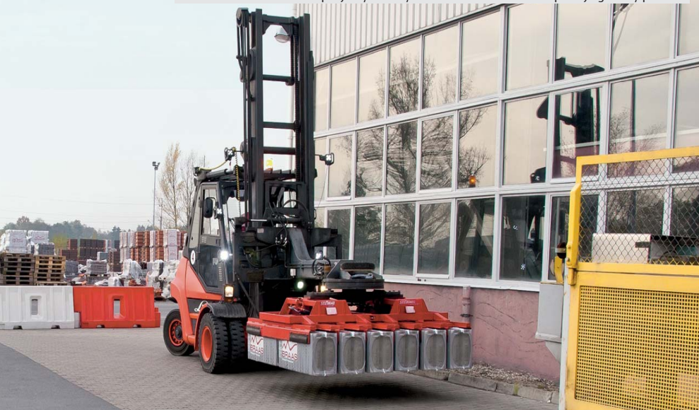
Wózek H80D z serii 396 specjalnym chwytnikiem do dachówki transportuje gotowy produkt.
